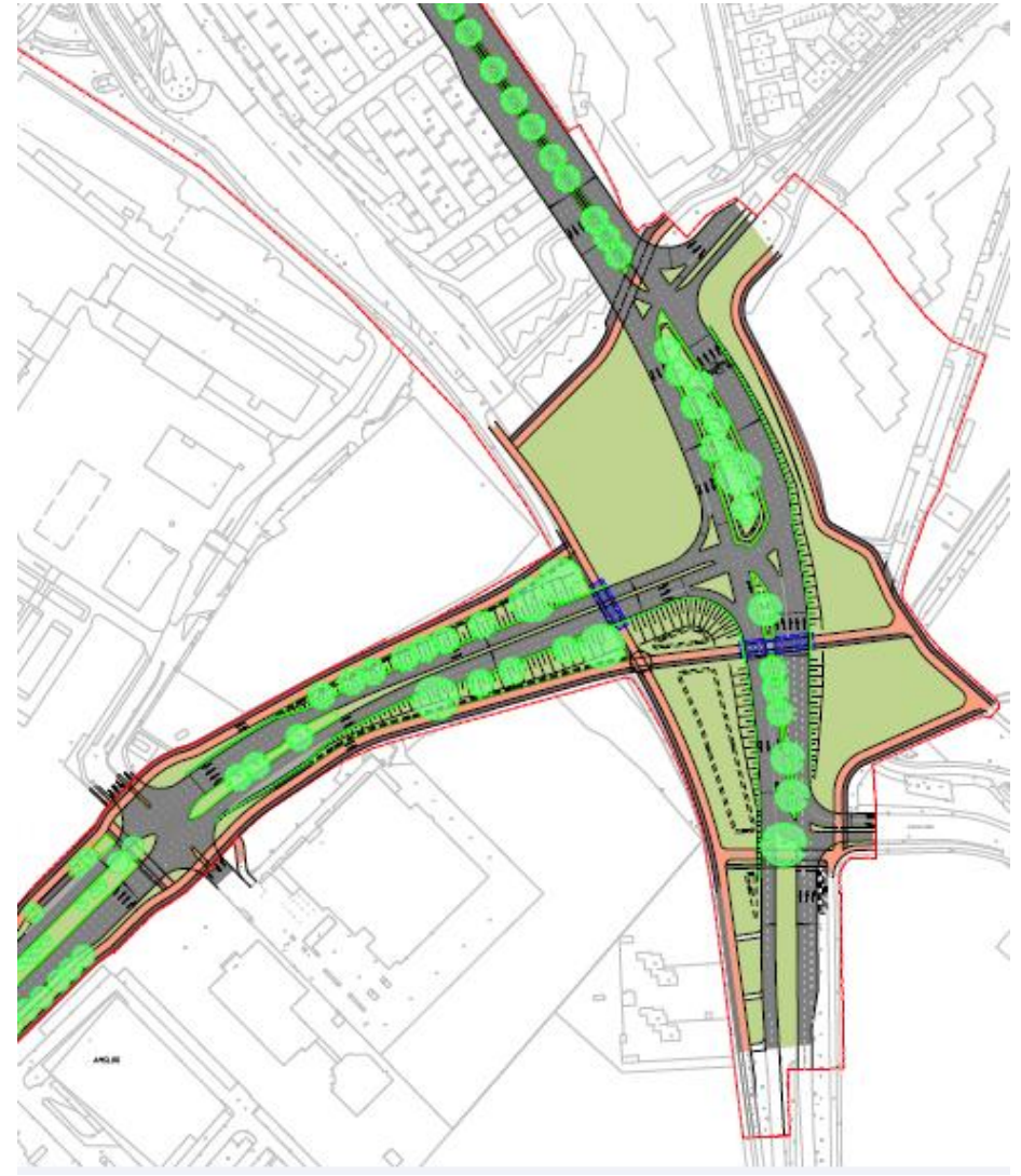
Schema 2: Aanpassingen Jonkerbosplein: Verleggen S100 (Neerboscheweg), ophogen van kruispunt en aanleg twee onderdoorgangen.
