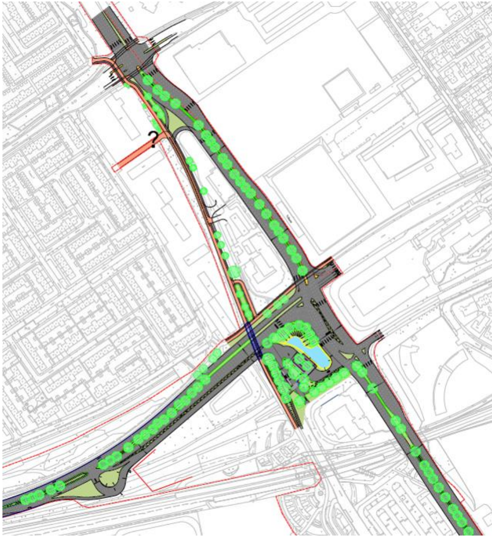
Schema 1: Aanpassingen Mandelaplein: Verleggen S100 (Neerboscheweg) en Graafseweg vanaf de brug tot Nelson Mandelaplein. De toegang tot Talis is nog onderwerp van gesprek.
