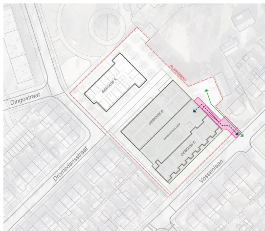
Figuur 7: Ontsluiting parkeergarage variante 1
