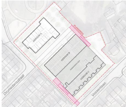
Figuur 13: Ontsluiting parkeergarage combinatie 2
