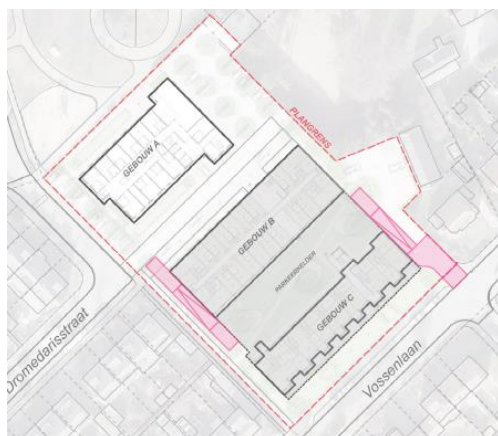
Figuur 12: Ontsluiting parkeergarage combinatie 1
