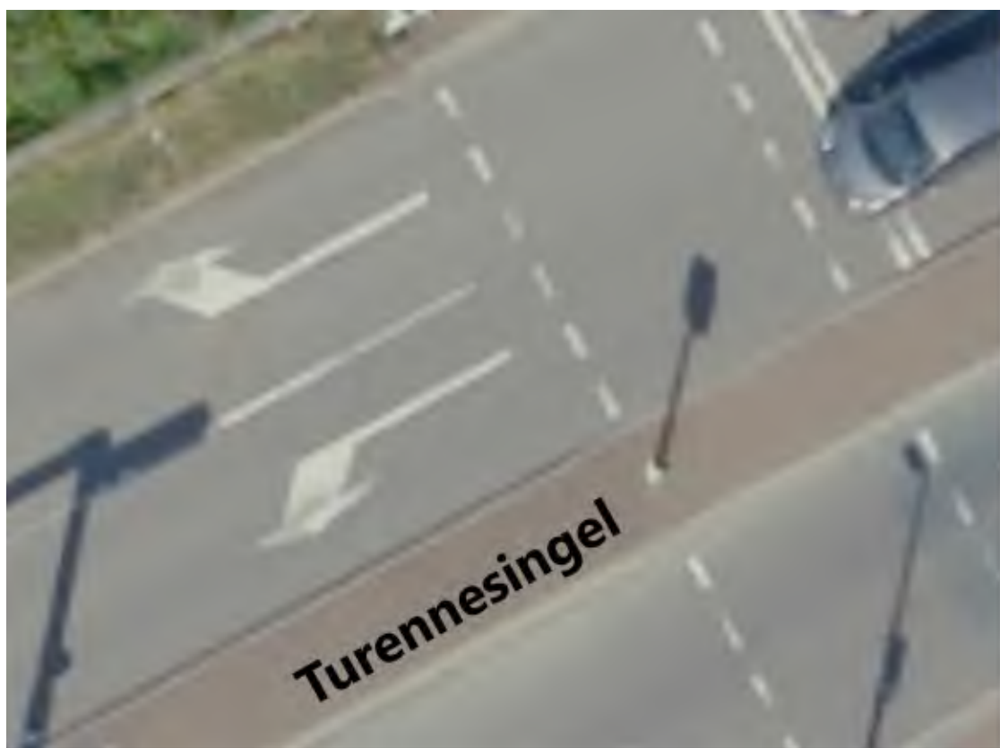
Aanpassing voorsorteerstroken voor betere doorstroming 1 (reeds uitgevoerd)
